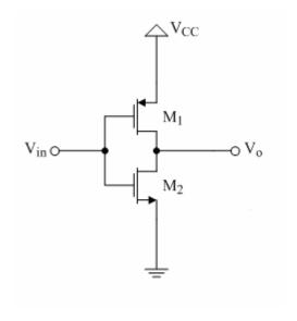
Fig. 2. CMOS inverter.
