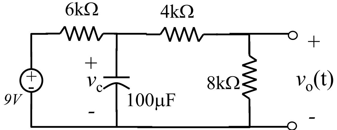
$$v_o(\infty) = \frac{8k\Omega}{6k\Omega + 4k\Omega + 8k\Omega} 9V = 4V$$
