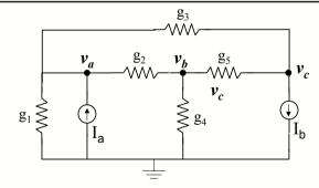
$$(a) g_1 v_a + g_3 (v_a - v_c) + g_2 (v_a - v_b) = I_a$$
