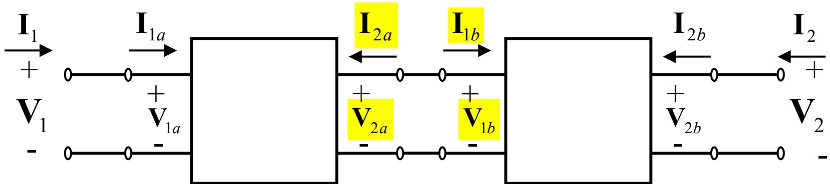
$$\begin{bmatrix} \mathbf{V}_{1a} \\ \mathbf{I}_{1a} \end{bmatrix} = \begin{bmatrix} A_a & B_a \\ C_a & D_a \end{bmatrix} \begin{bmatrix} \mathbf{V}_{2a} \\ -\mathbf{I}_{2a} \end{bmatrix}$$
