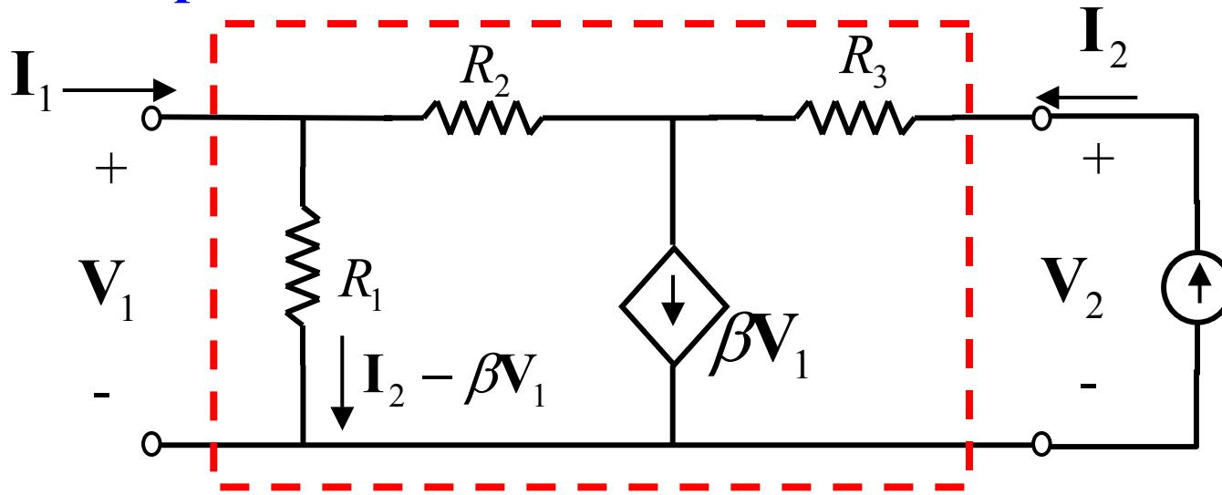
$$V_2 = R_3 I_2 + (R_1 + R_2)(I_2 - \beta V_1) = (R_1 + R_2 + R_3)I_2 - (R_1 + R_2)\beta V_1$$
